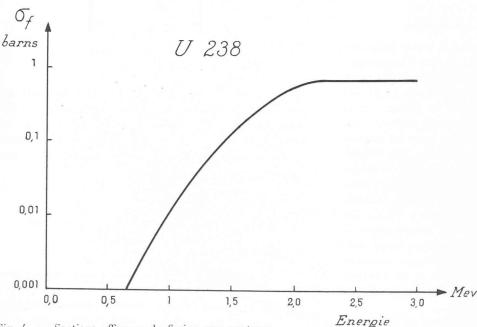
Fig. 4. — Sections efficaces de fission par neutrons des uraniums 238 et 235.
