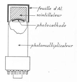
Fig. 12. — Schéma d'un compteur à scintillations.
