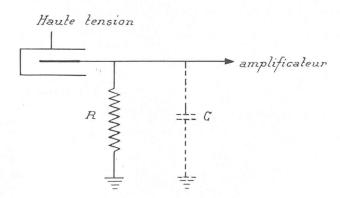
Fig. 11. — Chambre d'ionisation pour le comptage d'impulsions.  $R={
