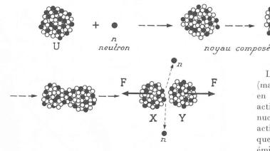
Fig. 6. — Schéma de la fission d'un noyau d'uranium par l'action d'un neutron.
