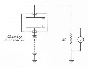
Fig. 10. — Chambre d'ionisation intégrante.  $R = \text{résistance} \qquad V = \text{voltmètre}$
