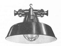
Fig. 7. — Lanterne pour milieux explosifs, équipée d'une lampe à incandescence de 100 ou 200 W. Lanterne en alliage Al-Si-Mg; vasque de fermeture en verre pressé; grille de protection, entrées de câbles latérales étanches.
