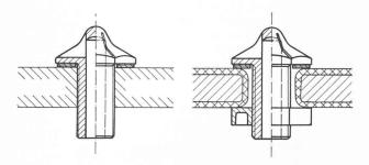
Fig. 7. - Crépine pour des filtres fermés.
