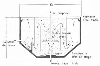
Fig. 5. — Le bloc d'épuration S.G.E.A.
