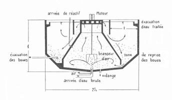
Fig. 4. — L'Aéro-Accélérator Degrémont.
