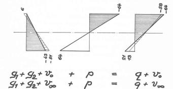
Cas de charge c) les tensions sont positives à l'arête inférieure d'environ 20 kg/cm².
