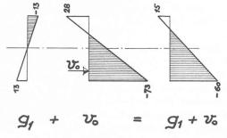
Cas de charge a) les tensions sont positives à l'arête supérieure d'environ 15 kg/cm².
