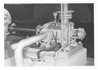
Fig. 4. — Vue de la pompe Sulzer. On distingue le palier classique avec le presse-étoupe et les robinets de réglage de la stabilité des manomètres mesurant la pression de refoulement.
