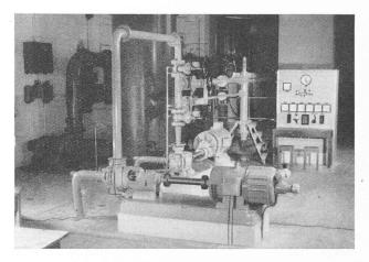
Fig. 2. — Vue générale de l'installation. Au premier plan, le groupe Egger, au deuxième plan le groupe Sulzer, plus en arrière, l'injecteur et le tableau de commande et de mesure.
