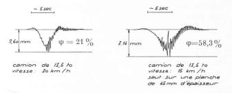
Fig. 9. — Mesures dynamiques. (Avant la pose du revêtement d'asphalte.)
