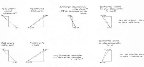
Fig. 7. — Diagrammes des contraintes dans la section médiane du pont.
