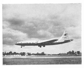
Le Brabazon, tentative hardie entre toutes: quatre hélices coaxiales contrarotatives absorbent la puissance de quatre groupes de turbopropulseurs Proteus jumelé de 6400 ch par groupe (à l'arrêt, altitude 0 m, plus 715 kg de poussée), logés dans l'aile (soit **25.600 ch**) ( $\varnothing$  hélice = 4,88 m).
