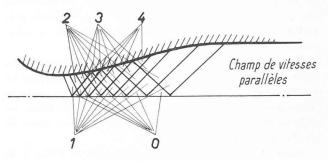
Fig. 8 c. — Schéma de la détente dans la tuyère.
