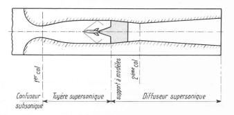
Fig. 4. — Schéma de la section de mesure.
