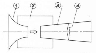
Fig. 2. — Soufflerie à circuit ouvert, du type Eiffel.
