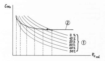
Fig. 4. — Variation de  $c_{w_0}$  en fonction de  $Re_{vol}$ .
