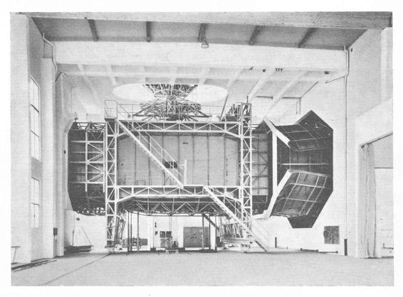
Fig. 3. — Chambre d'expérience mobile de la grande soufflerie.
