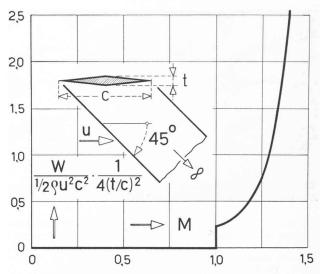
Fig. 9. — Résistance d'ondes d'un profil supersonique en fonction du nombre de Mach.
