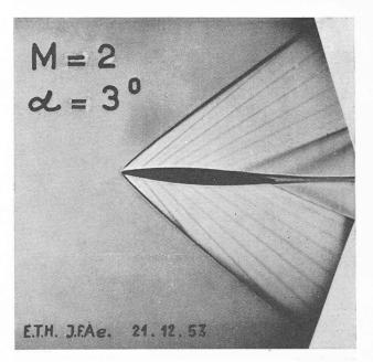
Fig. 10. — Prise de vue strioscopique d'un profil supersonique au nombre de Mach 2.
