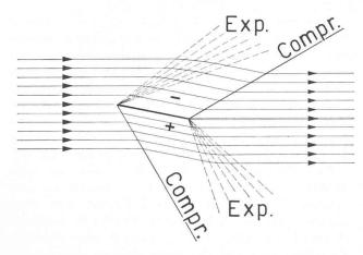
Fig. 14. — Ecoulement supersonique autour d'une plaque plane avec angle d'attaque.
