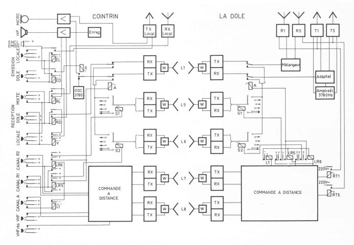
Fig. 3. — Schéma de détail d'une place de travail du centre de contrôle régional et les appareils s'y rapportant.
