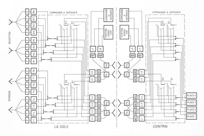
Fig. 1. — Schéma de principe des installations de radio-téléphonie pour le contrôle des voies aériennes.
