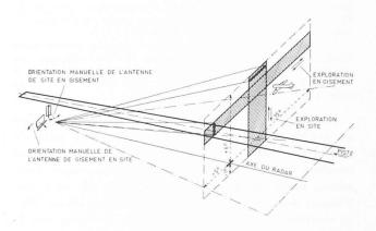
Fig. 7. — Couverture du radar d'approche de précision. L'antenne de gisement explore un secteur horizontal de 20° sur 2 à 3° de hauteur. Cette couverture peut être déplacée manuellement entre l'horizon et 6° de site. L'antenne de site explore de — 1° à + 6° sur une largeur d'environ 4°. Elle peut être orientée en gisement entre — 5° et + 15°.
