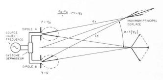
Fig. 3. — Deux dipôles A et B excités avec des courants égaux et des phases différentes fournissent un maximum de rayonnement dans une direction dépendant du déphasage.
