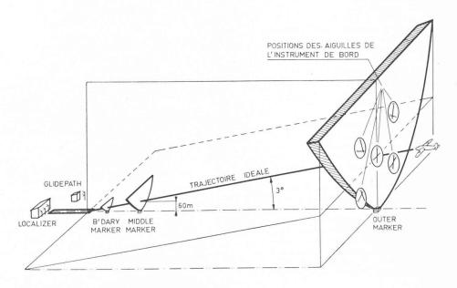
Fig. 1. — Vue d'ensemble montrant les cinq émetteurs de l'ILS, les faisceaux de rayonnement des radio-bornes et les positions des aiguilles sur la trajectoire idéale et dans les quatre quadrants.
