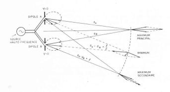
Fig. 2. — Deux dipôles A et B excités avec des courants égaux et la même phase additionnent leurs rayonnements en tout point de l'espace où la différence des chemins  $d_A$  et  $d_B$  est un nombre entier de longueurs d'ondes. Ces rayonnements se soustraient quand  $d_A - d_B$  est un nombre impair de demi-ondes.
