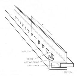
Fig. 5. — Vue schématique de l'antenne « Thomson-Houston » montrant la rangée de dipôles reliés au guide par l'antenne-sonde. Le « couteau » mobile sert à modifier le déphasage entre les dipôles, assurant ainsi l'exploration.
