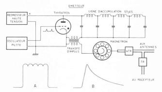
Fig. 10. — Schéma de principe de l'émetteur. Périodiquement, le thyratron décharge la ligne d'accumulation, en court-circuit à travers le transformateur d'impulsions qui transmet cette énergie au magnétron. Ce dernier la convertit en oscillations à hyperfréquence.
