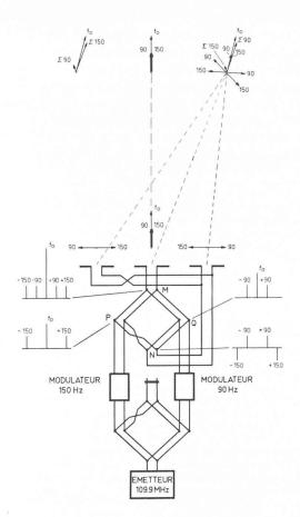
Fig. 2. — Schéma de principe de l'émetteur du «localizer» montrant l'annulation de la porteuse sur les antennes latérales (schémas spectraux) ainsi que la combinaison des vecteurs de rayonnement des antennes dans l'espace.
