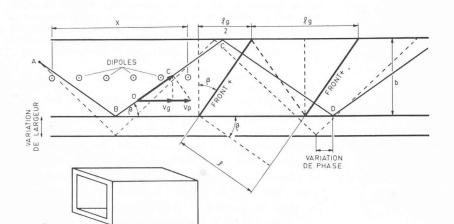
Fig. 6. — Fonctionnement du guide d'antenne. Une onde pénétrant dans un guide d'ondes se réfléchit sur les parois et se propage sans dispersion dans le tube conducteur. L'énergie se déplace à la vitesse  $v_g$  tandis que la phase se transmet à la vitesse  $v_p$ , plus grande que la vitesse de la lumière ;  $v_g \cdot v_p = C^2$  ;  $v_g$  et  $v_p$  varient en fonction de la largeur b du guide ce qui fournit un moyen de modifier les relations de phase entre dipôles.
