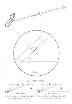
Fig. 12. — Diagramme illustrant la mesure de la distance et la correction de la forme des échos sur l'écran.
