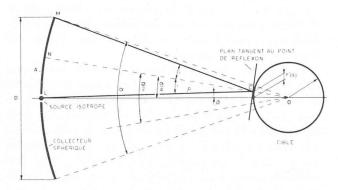
Fig. 1. — Une source de rayonnement L éclaire une sphère O. L'énergie qui touche la sphère dans un cercle de rayon r' (surface s) est réfléchie dans un collecteur A. La figure permet de calculer cette énergie réfléchie, c'est-à-dire la puissance de l'écho radio-électrique.
