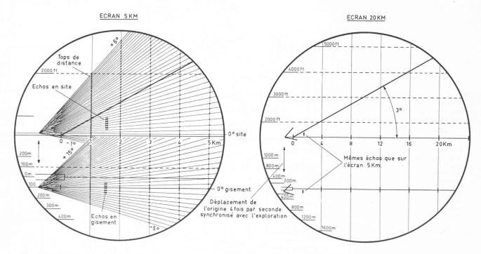
Fig. 9. — Les écrans. A gauche : écran 0-5 km montrant les balayages surintensifiés par les échos et les tops de distance.
