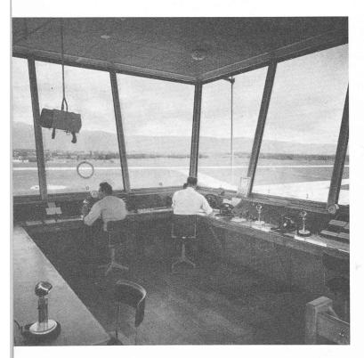
Vue intérieure de la tour de contrôle. Suspendue au plafond, la lampe à signaux qui permet de donner des ordres aux petits avions qui ne disposent pas d'appareils radio.
