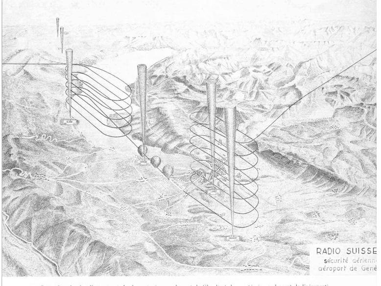
Carte des circuits d'attente et de descente (au nord-ouest de Gland) et de montée (au sud-ouest de l'aéroport). Ces circuits sont balisés par les radiophares de Gland, Versoix, Passeiry et Lancy. Au loin, vers le nord-est, la route tracée par Sottens et Berne vers Zurich.
