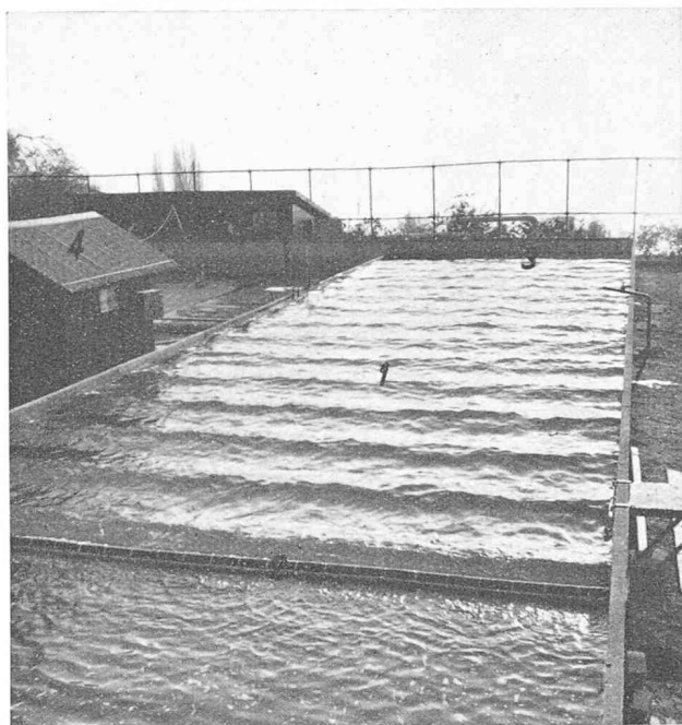
Fig. 5. — Vue générale du bassin construit pour les essais de la jetée Nord du port de Samsun.
