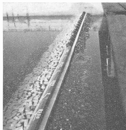
Fig. 20. — Le modèle après une tempête de 48 heures — essai 52. Avec variante I du couronnement : graves destructions du talus côté port. Avec variante II : quelques dégâts.
