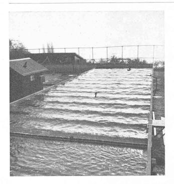
Fig. 5. — Vue générale du bassin construit pour les essais de la jetée Nord du port de Samsun. Bassin — 2. Jetée — 3. Générateur de houle — 4. Appareils enregistreurs.
