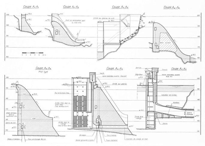
Fig. 4. — Barrage et prise d'eau. — Coupes verticales.
