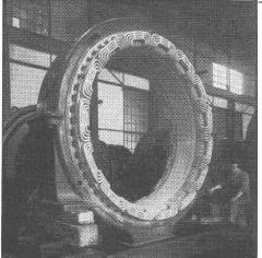
Rebobinages et transformations de moteurs, générateurs et transformateurs.
