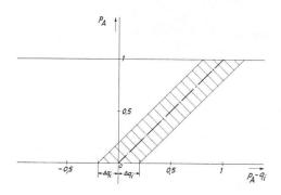
Fig. 7. — Centrales amont et aval sur services séparés. Variation de la puissance du service B en fonction de la puissance du service A et de la variation du débit des apports intermédiaires.
