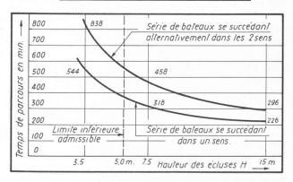
Fig. 3. — Détermination de la hauteur optimum des écluses.
