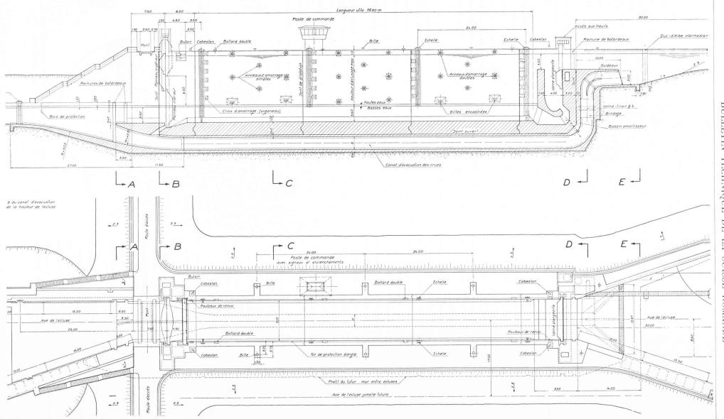
Fig. 6. — Ecluse-type du tronçon sud du canal d'Entreroches, avec évacuateur de crues sous le radier.
