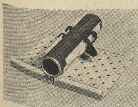
Le plafond ZENT-FRENGER diffère de tous les autres systèmes de chauffage par le fait qu'il est constitué de tuyaux suspendus au plafond dans lesquels circule l'eau chaude et auxquels des panneaux en aluminium sont fixés, ainsi que l'indique la gravure ci-contre.
