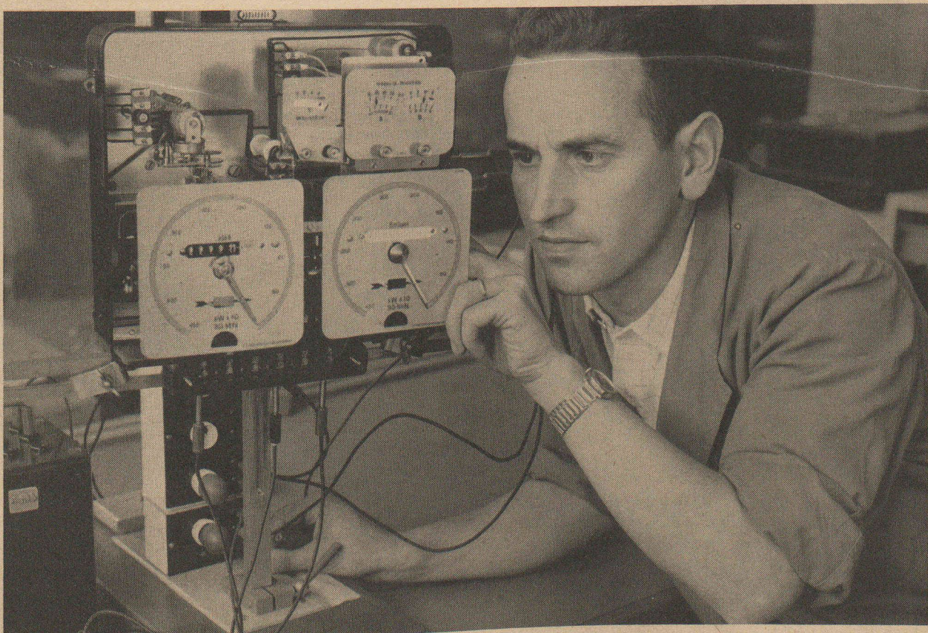
« Un Duomax », compteur pour le contrôle des charges moyennes sur le banc d'essais (chez Landis & Gyr S. A. à Zoug).
