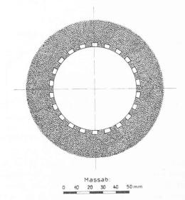
Fig. 12. — Filtre spécial en grain de quarz.
