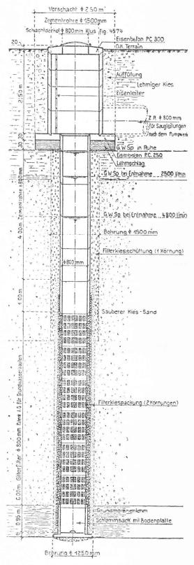
Fig. 1. — Puits filtrant vertical.
