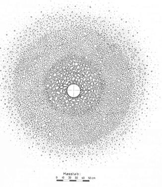
Fig. 6. — Forage horizontal. Tube filtrant avec couche de protection.
