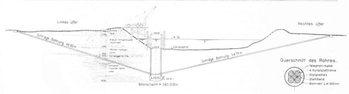
Fig. 14. — Passage du canal de la Thièle avec forages obliques à jet d'eau.
