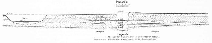
Fig. 16. — Captage horizontal dans le Jura. Courbes d'abaissement.
