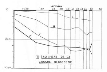
Fig. 48. - Tassement des repères dans le terrain.
