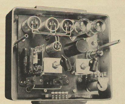
Inverseur électronique type REZU 103 des appareils électriques doit être au moins égale à celle des machines qu'ils commandent.
