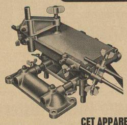
ne comporte pas moins de 21 pièces en fonte sous pression INCA et constitue un exemple classique de construction rationnelle et économique.
