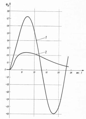
Fig. 16. — Variation de la vitesse résultant d'une variation de la charge selon une impulsion rectangulaire pour centrales à moyenne et à haute chute.
