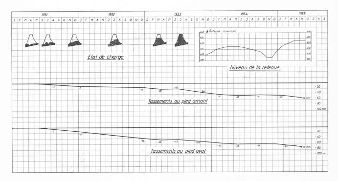
Fig. 20. — Tassements observés de 1951 à 1955 aux pieds amont et aval d'un contrefort.
