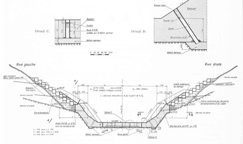
Fig. 18. — Bassin amortisseur. — Profil en travers type.
