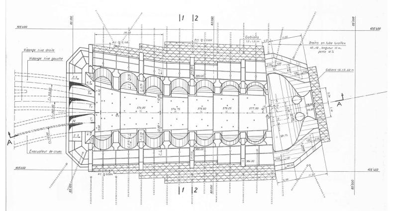
Fig. 17. — Bassin amortisseur. — Profil en long (coupe A—A) et plan de situation.
