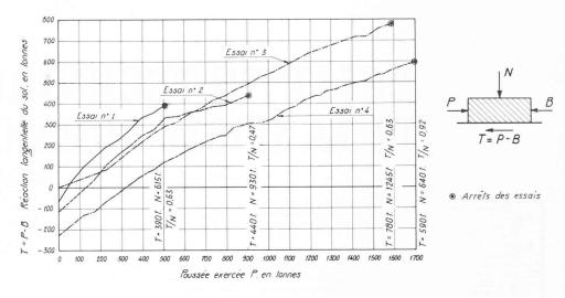
Fig. 8. — Essai de cisaillement à grande échelle. Variation de l'effort de cisaillement T en fonction de la poussée P.
