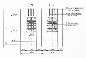
Fig. 14. — Vidanges de fond. Grilles amont en béton armé.
