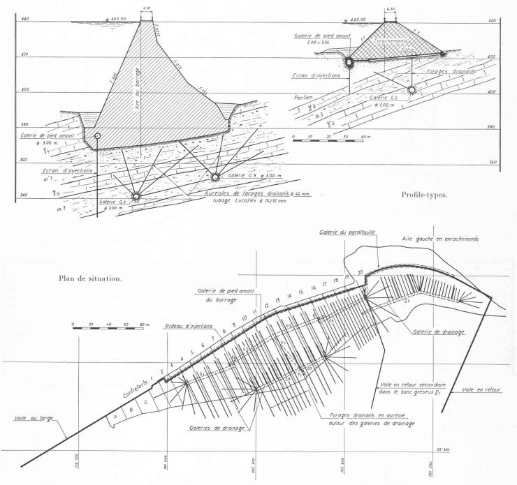
Fig. 11. — Etanchement et drainage du sol de fondation.
