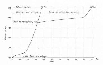
Fig. 13. — Débit maximum des vidanges et de l'évacuateur de crues en fonction du niveau de la retenue (toutes vannes ouvertes).
