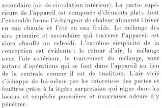
Dans la centrale, l'air frais pris à l'extérieur est purifié par un filtre fin, aspiré par un ventilateur et poussé dans le groupe de traitement d'air primaire. C'est là qu'il subit le chauffage ou le refroidissement préalable, l'humidification ou le séchage; il est ensuite dirigé vers les appareils « Jettair » par l'intermédiaire des conduites de faibles dimensions. Le traitement complémentaire s'effectue dans l'appareil individuel par l'eau
