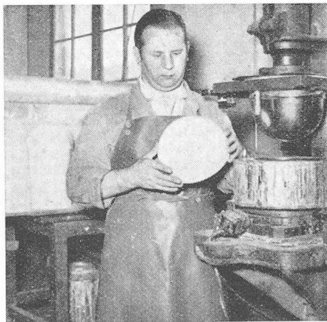
Fig. 5. — Moulage à la presse chauffante de calottes de casques « Looping » (Clématéite S. A., Vallorbe).
