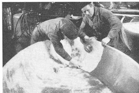
Fig. 1. — Fabrication d'une coque de bateau en « hand lay up » (Carrosserie Schoelly, Hauterive, Neuchâtel).
