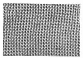
Fig. 9. — Tissu Vetrotex nº 374 armure toile pour couches de surface.
