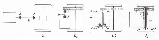
Fig. 1. — Dispositions adoptées pour les moteurs de traction et les transmissions à arbres à cardans des véhicules moteurs sur rails.
