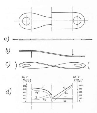
Fig. 3. — Sollicitation des lames de l'accouplement Sécheron. a= Traction. — b= Flexion. — c= Torsion. — d= Contraintes comparées des lames rectiligne et incurvée.  $\sigma_z=$  contrainte de traction. —  $\sigma_b=$  contrainte de flexion. —  $\tau=$  contrainte de torsion.  $\sigma=$  contrainte combinée.
