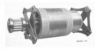
Fig. 2. — Transmission Sécheron à arbre à cardans, accouplements à lames et joints à créneaux.
