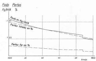
Fig. 1. — Poids et pertes de gros transformateurs 1930-1955.
