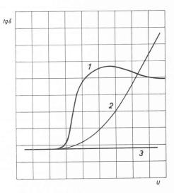
Fig. 2. — Représentation schématique de l'influence des couches d'air sur les pertes diélectriques d'un isolant. Variation de tgδ en fonction de la tension.
