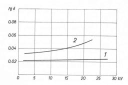
Tangente de l'angle de perte δ de l'isolation d'un turbo-alternateur de 66 MVA.
