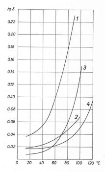
Comparaison entre différents isolants modernes tgδ en fonction de la température.
