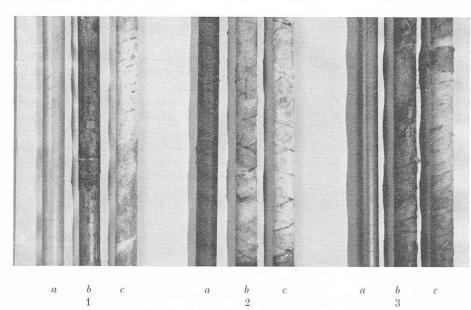
Fig. 6. — Echantillons d'isolation après quinze semaines d'effluvage dans un champ de  $42~\rm kV/cm.$
