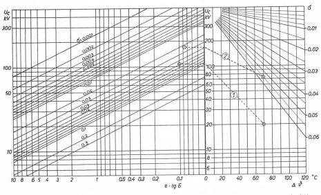
Fig. 1. — Nomogramme pour le calcul de la tension critique d'un cylindre refroidi à l'extérieur. Fréquence : 50 Hz. Coefficient de transmission de chaleur pour le micafolium :  $\lambda=1,8.10^{-3}$  W/°C.cm
