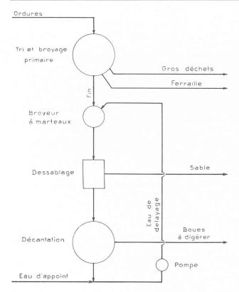
Fig. 4. — Schéma de principe du délayage des ordures.
