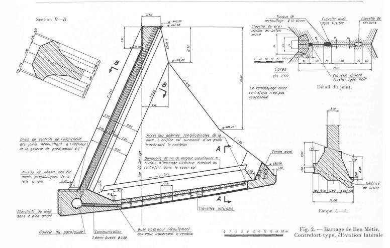
profil est sensiblement triangulaire; les fruits des parements amont et aval ainsi que la pente de l'assise des fondations ont été déterminés de manière à assurer aux contreforts une stabilité au glissement suffisante, à réaliser une répartition des contraintes sur le sol aussi uniforme que possible, tout en limitant le plus possible le volume total du béton.
