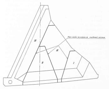
Fig. 4. — Découpage des contreforts pour l'exécution.
