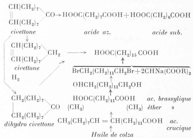
Le fait d'avoir pu transformer la civettone en un acide dibasique normal, c'est-à-dire non ramifié, contenant encore la totalité des atomes de carbone de la civettone, indiquait la présence d'un mégacycle avec 17 chaînons. Cette découverte ouvrit tout un chapitre nouveau de la chimie organique, le chapitre des produits mégacycliques. La chimie qui s'occupe de ces substances est en somme le pendant de la chimie des polymères (caoutchouc et matières plastiques).
