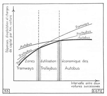
Fig. 3. — Rentabilité en fonction de la fréquence.
