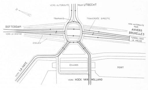
Fig. 4. — Plan schématique du carrefour des « Ecluses du Parc », à Rotterdam.
