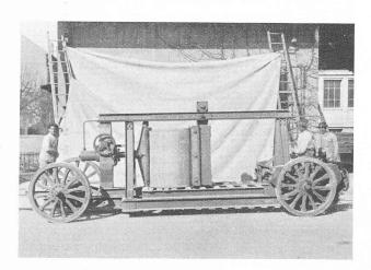
Fig. 1. — Presse hydraulique pour essai de résistance des tuyaux de ciment.
