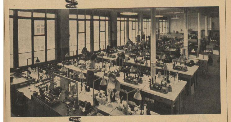
Le filament est l'âme de la lampe. Sa qualité en détermine le rendement lumineux et la durée de vie. Le filament ne peut pas être monté sous forme étirée dans l'ampoule, mais doit être boudiné préalablement c'est-à-dire spiralé très serré avec une méticuleuse précision.
