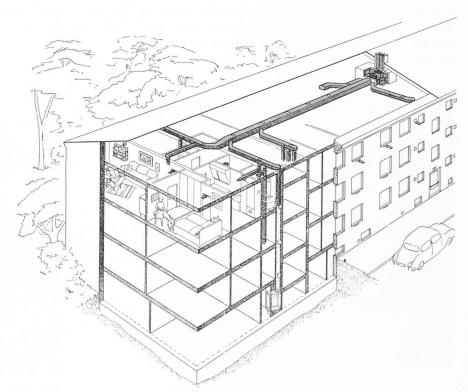
Fig. 1. — Schéma général d'une ventilation mécanique d'immeuble.
