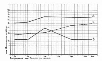
Fig. 4. - Amortissement du bruit d'un étage à l'autre.
