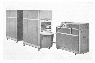
Fig. 4. — Vue d'une calculatrice à tambour magnétique, type 650.
