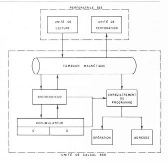
Fig. 5. — Schéma de fonctionnement de l'Unité arithmétique.
