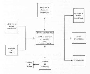
Fig. 7. — Schéma de fonctionnement d'une machine intégrée.
