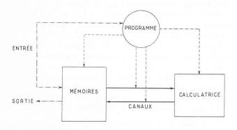
Fig. 1. — Schéma de principe d'un calculateur arithmétique.
