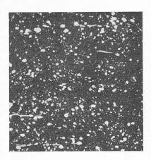
Structure Desegatized sulfinisée (Acier rapide Molybdène M-2) agrandissement 500 ×.
