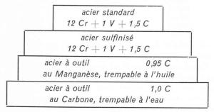
Comparaison entre l'usinabilité d'un acier 12 Cr, 1 V et 1,5 C Standard et Sulfinisé.
