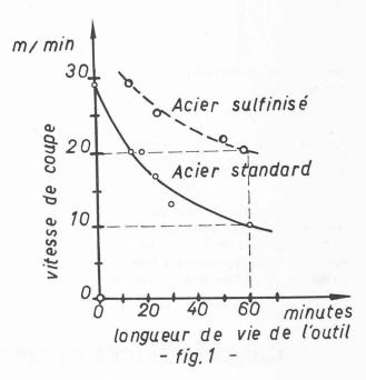
Fig. 1. — Comparaison entre la vitesse de coupe d'un acier Standard et celle d'un Sulfinisé. Essai effectué sur des barres de 75 mm de diamètre en acier indéformable à 13 % Cr et 1 % V, laminées à chaud et recuites, avec un burin en acier rapide M-2. Avance de 0,23 mm/tour; profondeur de passe de 1,57 mm, même huile soluble utilisée dans les deux cas.
