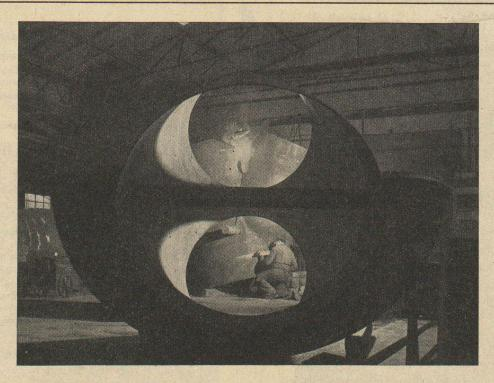
CHAUDRONNERIE: Culotte pour conduite forcée d'usine électrique (Les Clées).
