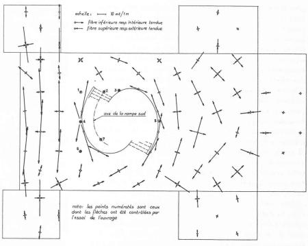
Fig. 5. — Corps intermédiaire — Direction et grandeur des moments principaux pour un certain nombre de points du cas de charge I, soit poids propre + 400 kg/m² de surcharge sur toute la dalle et les 2 rampes (les parois sont rabattues dans le plan de la dalle).
