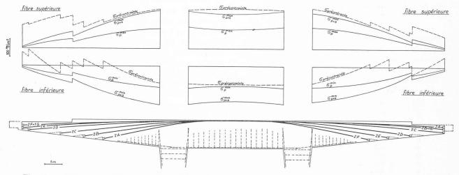
Fig. 10. — Bâtiment de l'Entrée — Plan schématique du câblage et contraintes correspondantes pour une console,
