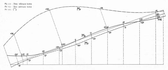
Fig. 6 — Moments fléchissants (en tm)  $M_x$  et  $M_y$  et moments de torsion  $M_t$  de la rampe sud pour le cas de charge I (chiffres entre parenthèses : contrôle de  $M_x$  par jauges électriques).
