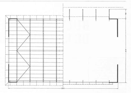
Fig. 1. — Pavillons sud — Plan de la charpente — Echelle 1:600.
