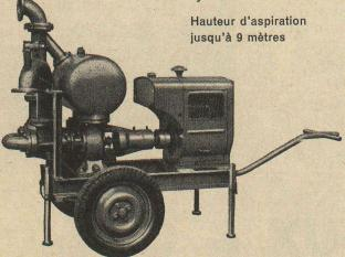
Débits de 1 à 500 litres/seconde. — Pas de soupape de pied, ni de clapet dans la tubulure d'aspiration. — Aucune pompe à vide de secours. — Réamorçage automatique immédiat, même si de l'air est entré dans le tuyau d'aspiration. — Pas de surfaces de contact à frottement et s'usant; par conséquent pas de contretemps même pour l'élévation de la boue, du sable ou du gravier.
