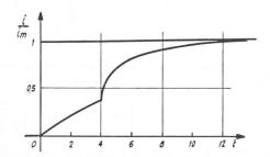
Fig. 17. — Variation du courant dans un circuit électrique formé d'une résistance et d'une inductance saturable.
