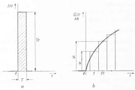
Fig. 5. — Définition de la réponse impulsionnelle  $G_{AB}(t)$  d'une grandeur B à une variation de la grandeur A selon une impulsion unitaire I(t).
