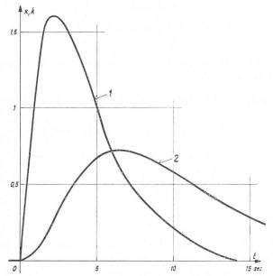
Fig. 12. — Réponse du dispositif mécanique à une variation de la force selon une allure quelconque. Courbe 1: variation relative de la force K. Courbe 2: variation relative de la course du point X.
