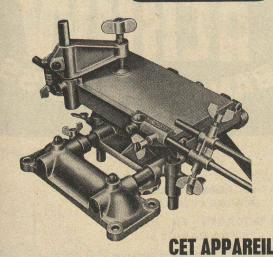
ne comporte pas moins de 21 pièces en fonte sous pression INCA et constitue un exemple classique de construction rationnelle et économique.
