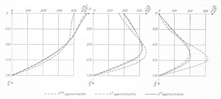
Fig. 2. — Plaque carrée, simplement appuyée le long des trois côtés  $x=0,\ x=a,\ y=b,$  soumise à une pression hydrostatique  $p=\gamma y$ . Cas où  $\lambda=0,2$  et  $\nu=0,25$ . Diagrammes des grandeurs  $\zeta,\ M_x$  et  $M_y$  le long de l'axe vertical de la plaque (x=a/2), pour les trois premières approximations.
