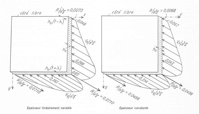
Fig. 7. — Plaque carrée, d'épaisseur linéairement variable ( $\lambda = 0,2$ ) ou constante, appuyée le long de trois côtés et soumise à une pression hydrostatique  $p = \gamma y$ . Diagrammes des réactions  $V_x$ ,  $V_y$  réparties le long des côtés et valeurs des réactions locales R appliquées aux sommets du contour.
