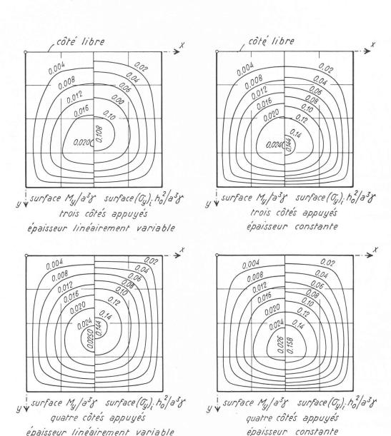
Fig. 5. — Plaque carrée, d'épaisseur linéairement variable ( $\lambda$ =0,2) ou constante, appuyée le long de trois ou de quatre côtés et soumise à une pression hydrostatique  $p = \gamma y$ . Surfaces  $\frac{M_y}{a^3\gamma}$  et  $\frac{(\sigma_y)_i\,h_0^2}{a^3\gamma}$ , pour  $\nu = 0,25$ .
