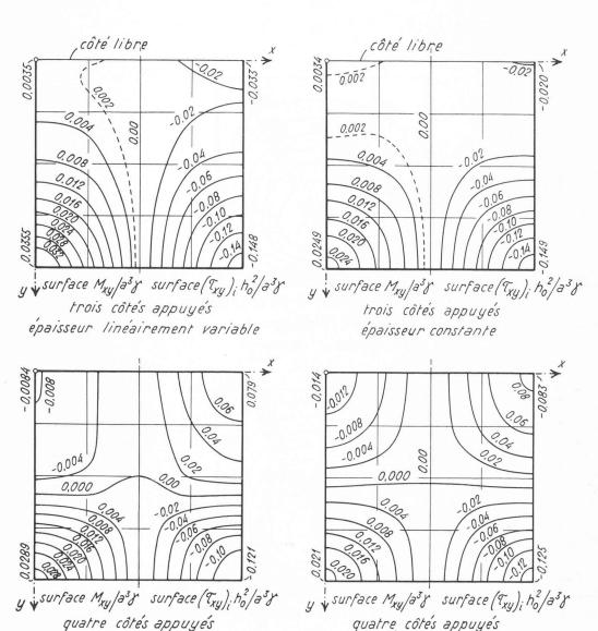
Fig. 6. — Plaque carrée, d'épaisseur linéairement variable ( $\lambda$ =0,2) ou constante, appuyée le long de trois ou de quatre côtés et soumise à une pression hydrostatique  $p=\gamma y$ . Surfaces  $\frac{M_{xy}}{a^3\gamma}$  et  $\frac{(\tau_{xy})ih_0^2}{a^3\gamma}$ , pour  $\nu=0,25$ .
