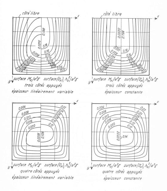
Fig. 4. — Plaque carrée, d'épaisseur linéairement variable  $(\lambda=0,2)$  ou constante, appuyée le long de trois ou de quatre côtés et soumise à une pression hydrostatique  $p=\gamma y$ . Surfaces  $\frac{M_x}{a^3\gamma}$  et  $\frac{(\sigma_x)_i\,h_0^2}{a^3\gamma}$ , pour  $\nu=0,25$ .
